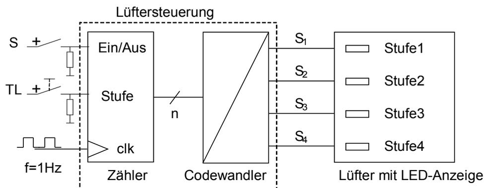
Lüftersteuerung mit digitalen Bauteilen.
