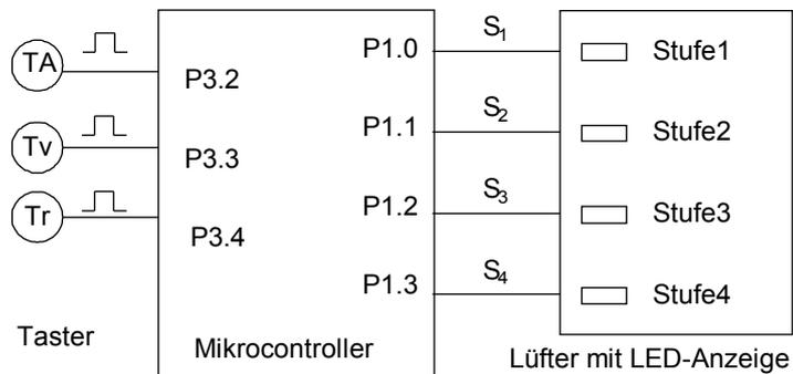
Das Ein- und Ausschalten des Lüfters soll mittels externem Interrupt geschehen, in dessen Serviceroutine ein Einschaltflag gesetzt bzw. zurückgesetzt wird. Beim Einschalten der Dunstabzugshaube läuft sie zunächst in Stufe 1.
